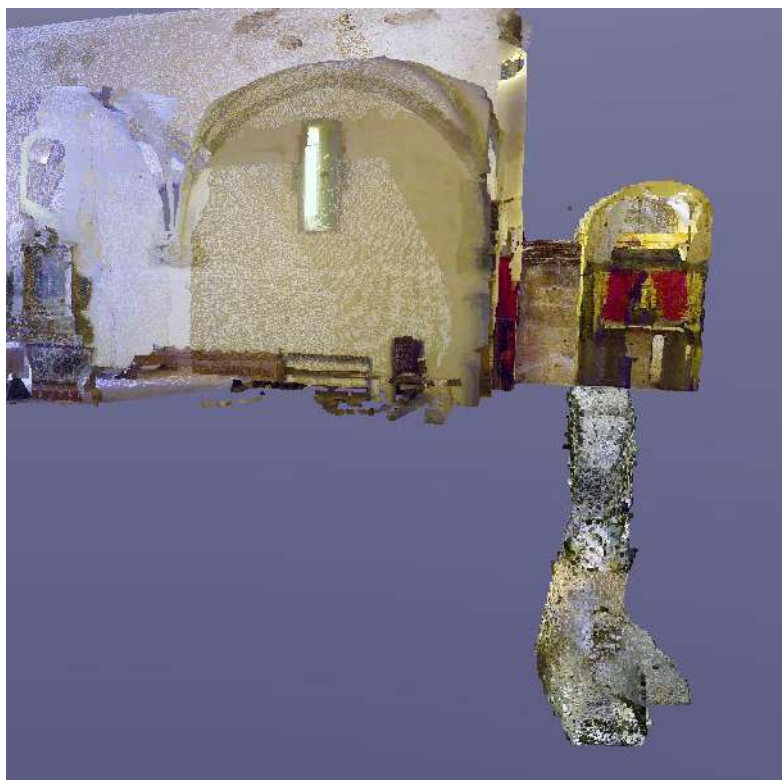
Vistes del resultat del núvol de punts aconseguit amb l'aixecament planimètric amb escàner làser.
